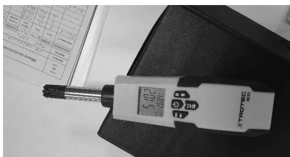
Figura 3.1. Rilevazione dei parametri termoigrometrici dell'aria
