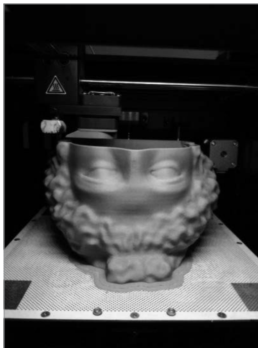
Figura 13.1. Processo di stampa FDM
