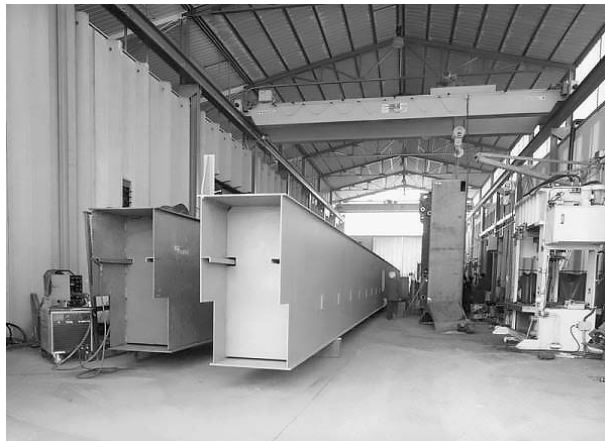
Figura 2.20. Vie di corsa per carroponte
