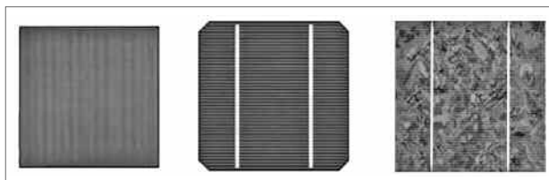
Figura 11. Cella in silicio amorfo, monocristallino e policristallino (fonte Enel)
